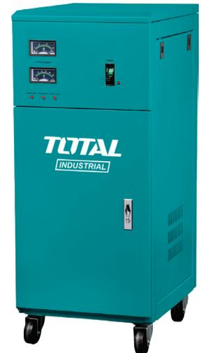
VOLTAJE 120-250 | 30kVA CAPACIDAD NOMINAL | >184V ±4V PROTECCIÓN BAJO VOLTAJE | >246V ±4V PROTECCIÓN SOBREVOLTAJE | 124 Kg PESO NETO
