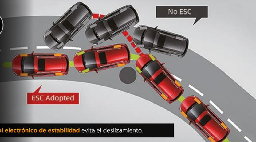
El **control electrónico de estabilidad** evita el deslizamiento.
