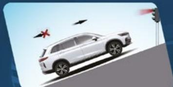
El sistema de asistencia de arranque en pendiente evita el deslizamiento
