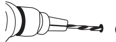
2. Utilice un taladro y una broca para concreto y barrene sobre las marcas; puede utilizar un clavo y martillo para hacer una pequeña marca que sirva de guía.
