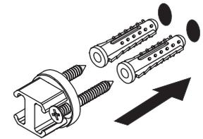
4. Coloque el soporte (E) sobre el ancla (B), por la parte de abajo rosque el opresor (D) y apriete hasta fijar firmemente.
