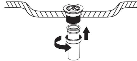
2.- Coloque el empaque (D) en la parte superior del tubo ceja (E). Enseguida introduzca la tuerca de acople (F) en el tubo y únalo a la parte inferior del contrafregadero roscando la tuerca de acople.
