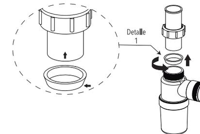
4.- Después inserte la tuerca de acople (G) y el empaque (H) por la parte inferior del tubo ceja (E). Conecte el bote (I) al tubo (E) y rosque la tuerca de acople (G).
