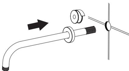
1.- Coloque cinta selladora en un extremo del brazo (no incluidos) y rósqelo firmemente a la salida del agua, si es necesario utilice una llave inglesa. Use una franela entre la llave y el brazo para no maltratar el producto, posteriormente deslice el chapetón (no incluido) hacia el muro.
