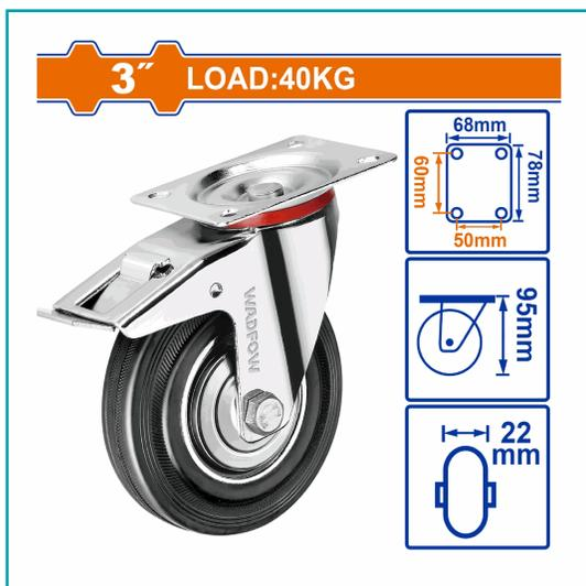
Rueda Giratoria De 3" Con Freno Carga: 40Kg Material De La Rueda: Acero + Goma Diámetro De La Rueda: 3" (75Mm )Ancho De La Rueda: 22Mm Rodamiento: Rodamiento De Rodillos Material Del Marco: Chapa Laminada
