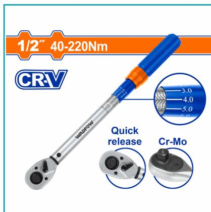
**\*Nombre:** Torquímetro 1/2"-40-220Nm. Cr-V. Liberación rápida. Cr-Mo. Long: 430mm. Tolerancia de torque: ±4%
